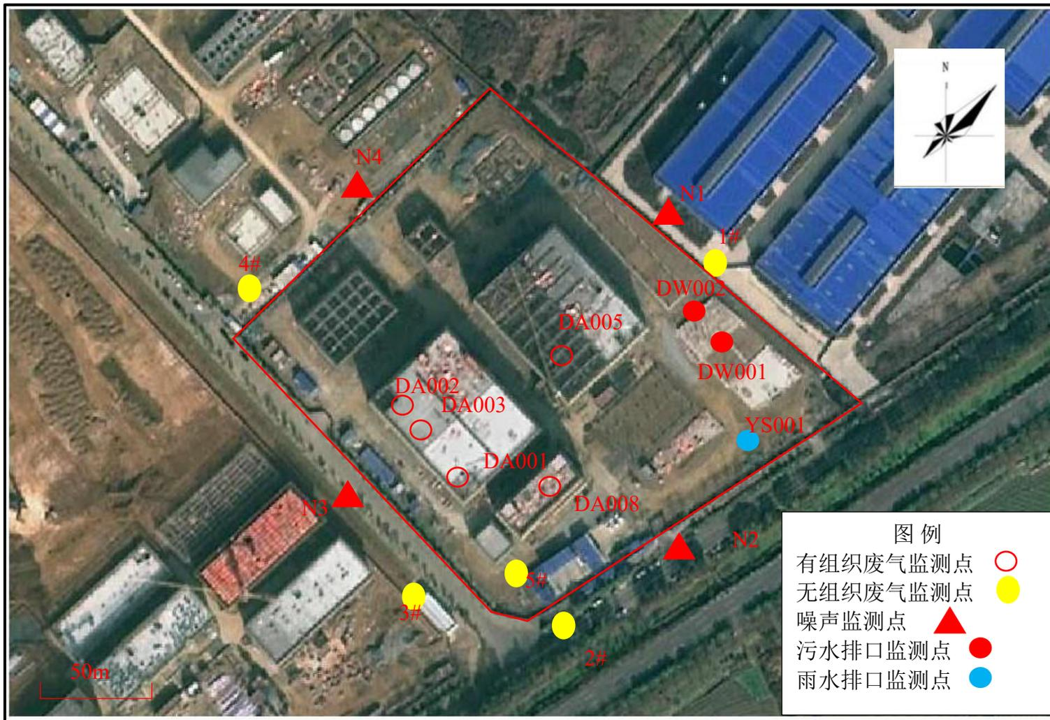
图 7-1 废水、废气、噪声检测点位图
