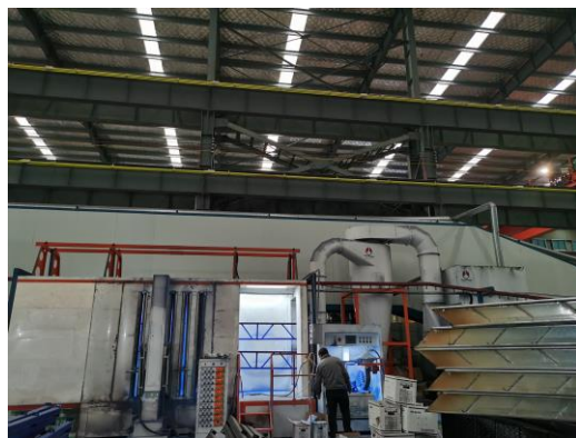
图 3-5-1 自动喷塑废气 TW002 除尘器
