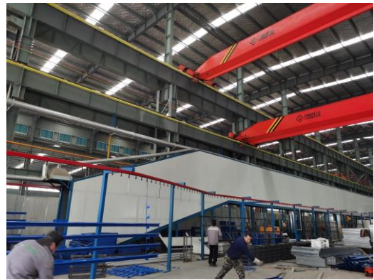
图 3-6-3 自动固化生产线西侧集气罩
