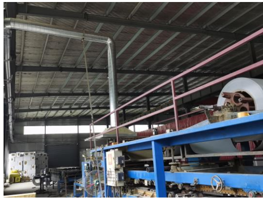
图 3-2-1 复合废气集气罩及集气管图
